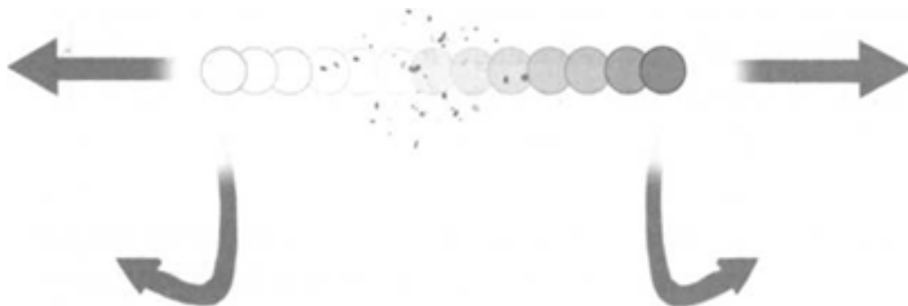
Par electrón/positrón producido por un fotón energético
